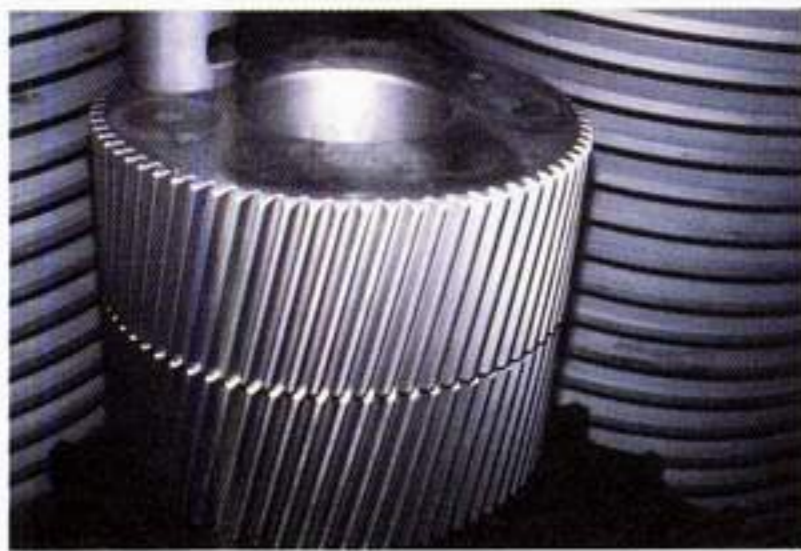
Bild 2 Gasnitrierte Stirnräder aus 42 Cr Mo 4
