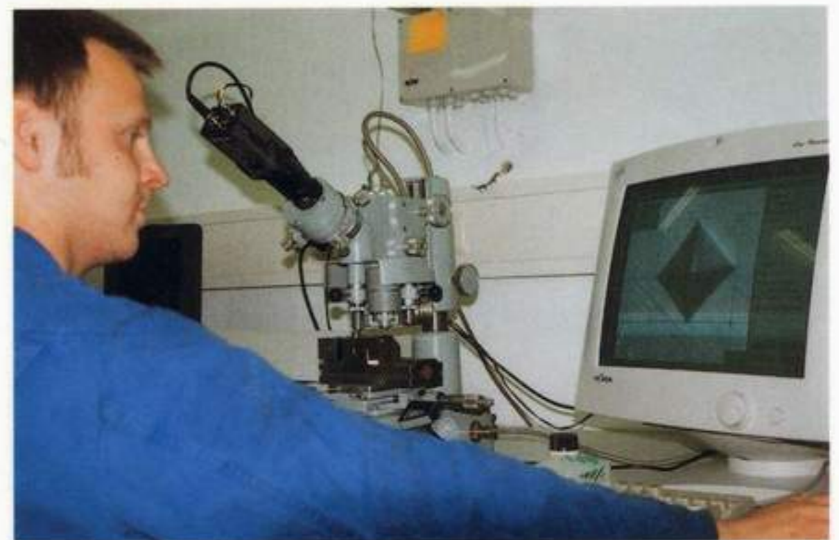
Qualitätsprüfung: Aufzeichnung der Härteverlaufskurve zur Bestimmung der Einhärtetiefe.
